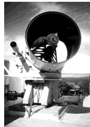
Рис.10. Спеціалізований лазерний телескоп ТПЛ-1М.
